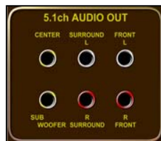
Abbildung 1 5.1ch Audio connection DVD Player und A/V Amplifier
